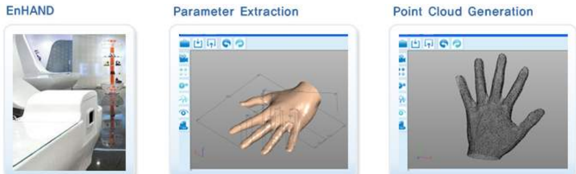
[프로토콜 그림 21] 손 스캔 시스템 및 데이터 처리 결과
